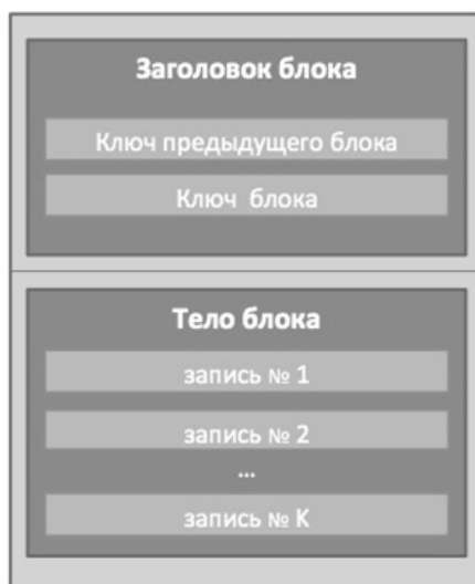
Рисунок 1. Структура блока в Blockchain
