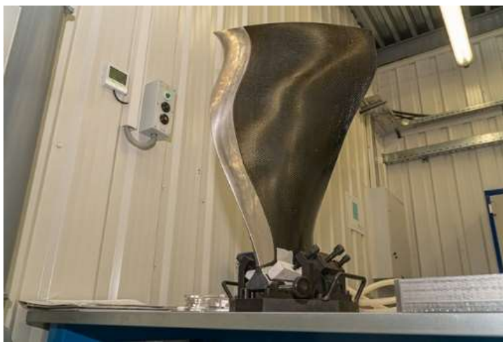
Рисунок 3. Рабочая лопатка вентилятора двигателя ПД-14 из ПКМ
