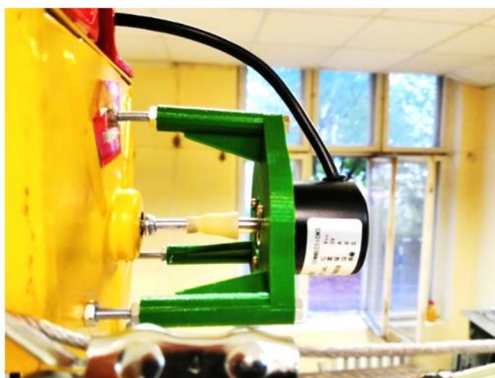
Рисунок 2. Энкодер, измеряющий обороты барабана
