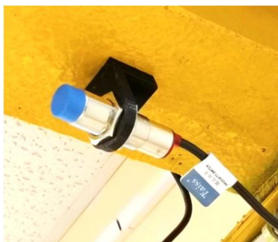
Рисунок 4. Индуктивный датчик, закрепленный на балке
