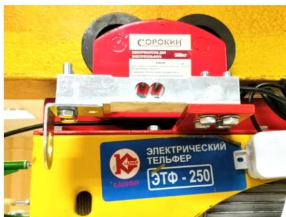
Рисунок 3. Тензодатчик, закрепленной на тельфере
