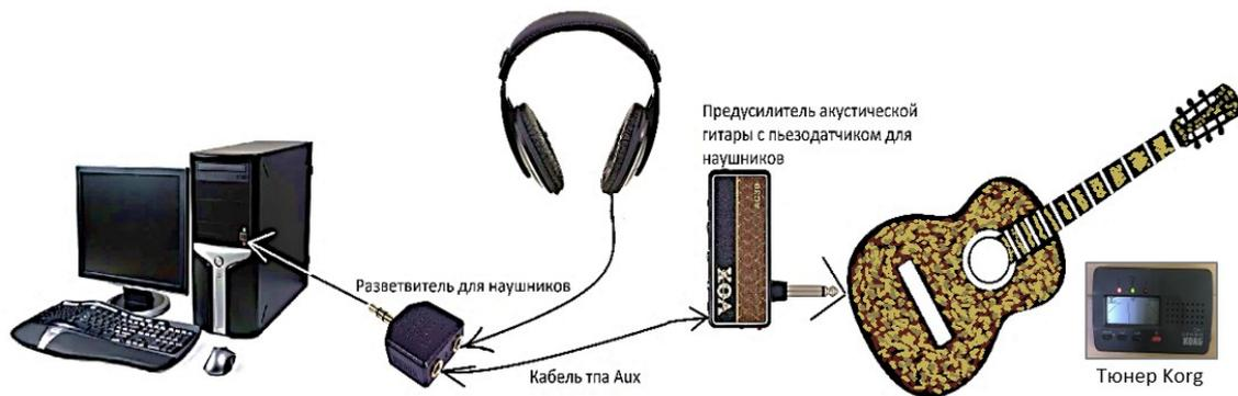
**Рисунок 3. Схема подключения звукозаписывающей аппаратуры**
