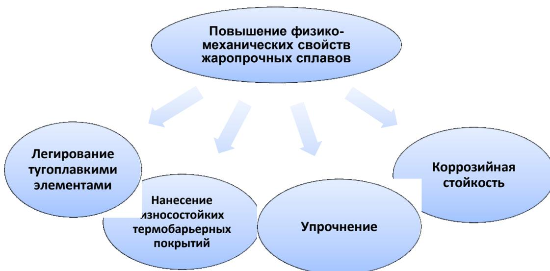
**Рисунок 1. Методы повышения физико-механических свойств жаропрочных сплавов**
