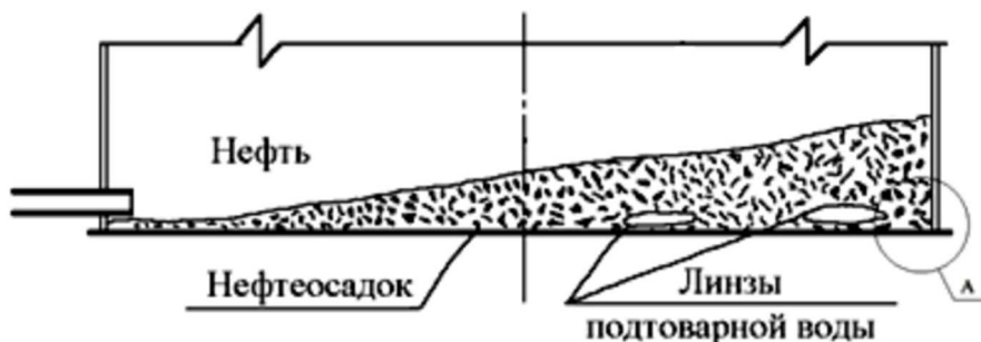
Рисунок 1. Распределение нефтеосадка в РВС
