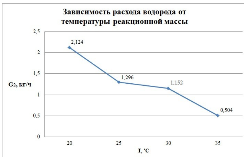
Рисунок 2. Зависимость расхода водорода от температуры реакционной массы
