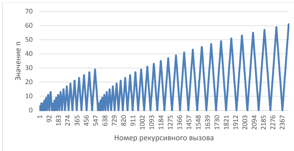
Рисунок 6. Значение аргумента n в зависимости от номера вызова для A(3, 3) . Вызовы приведены в хронологическом порядке
