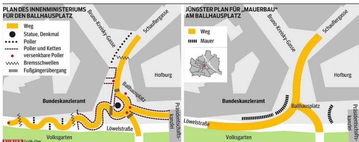
**Рисунок 3. Предложение по повышению безопасности за счет искривления дорожного полотна с дополнительными мерами препятствия разгона [7]**
