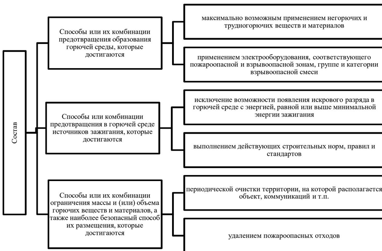
**Рисунок 1. Система обеспечения пожарной безопасности**
