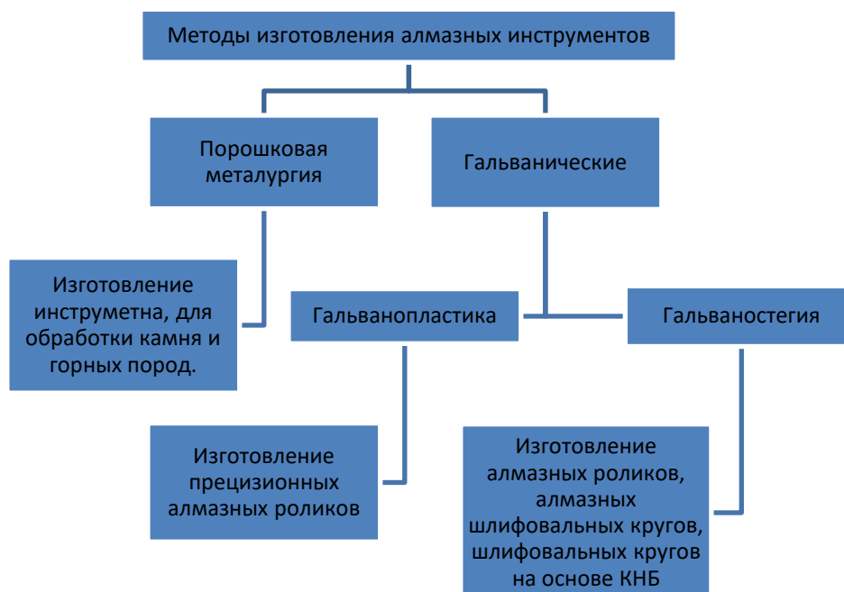
Рисунок 1. Методы изготовления алмазных инструментов
