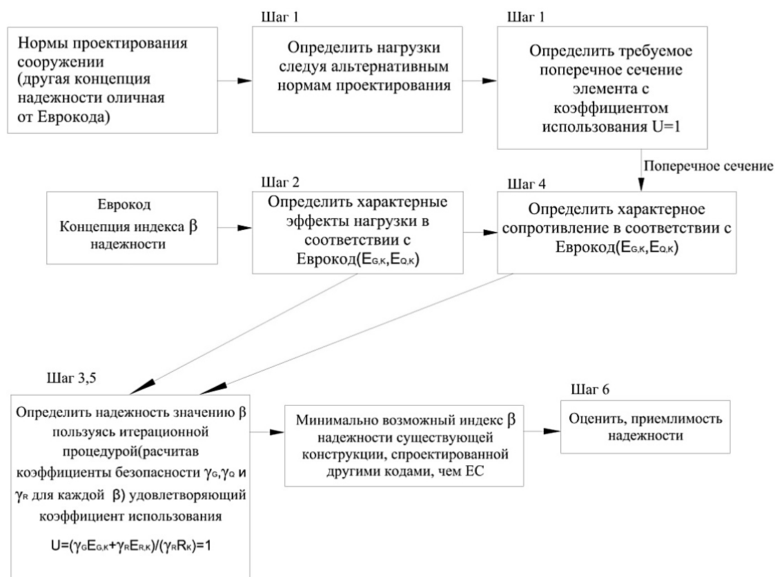
Рисунок 1. Процедура определения минимального индекса надежности \beta существующей конструкции, разработанной по кодам, отличным от ЕС
