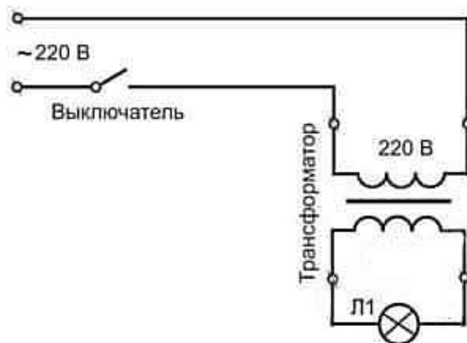
Рисунок 3. Электрическая схема подключения галогенной лампы, работающей от постоянного тока
