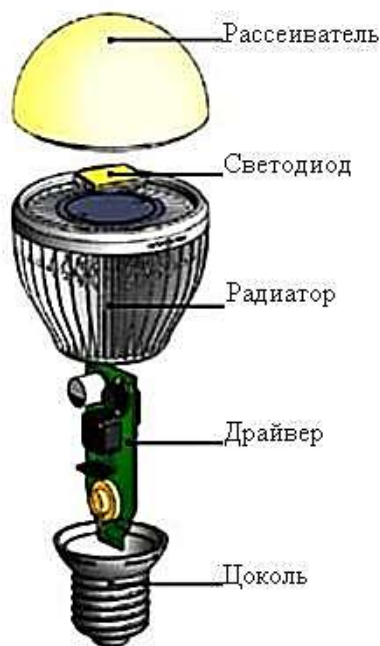
Рисунок 8. Конструкция LED лампы
