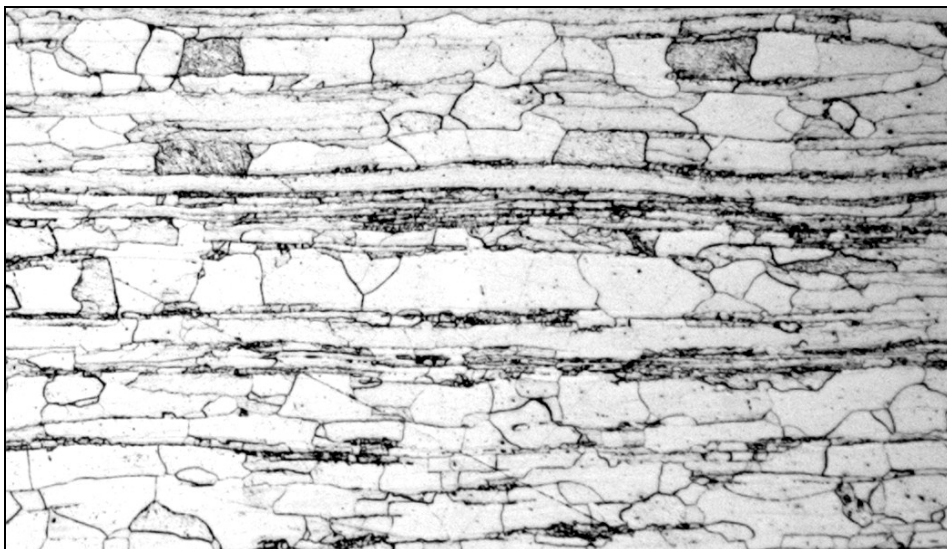
Рисунок 2. Структура горячекатаной электротехнической анизотропной стали, \times 100 травление – 3 % раствором \text{HNO}_3 на спирту
