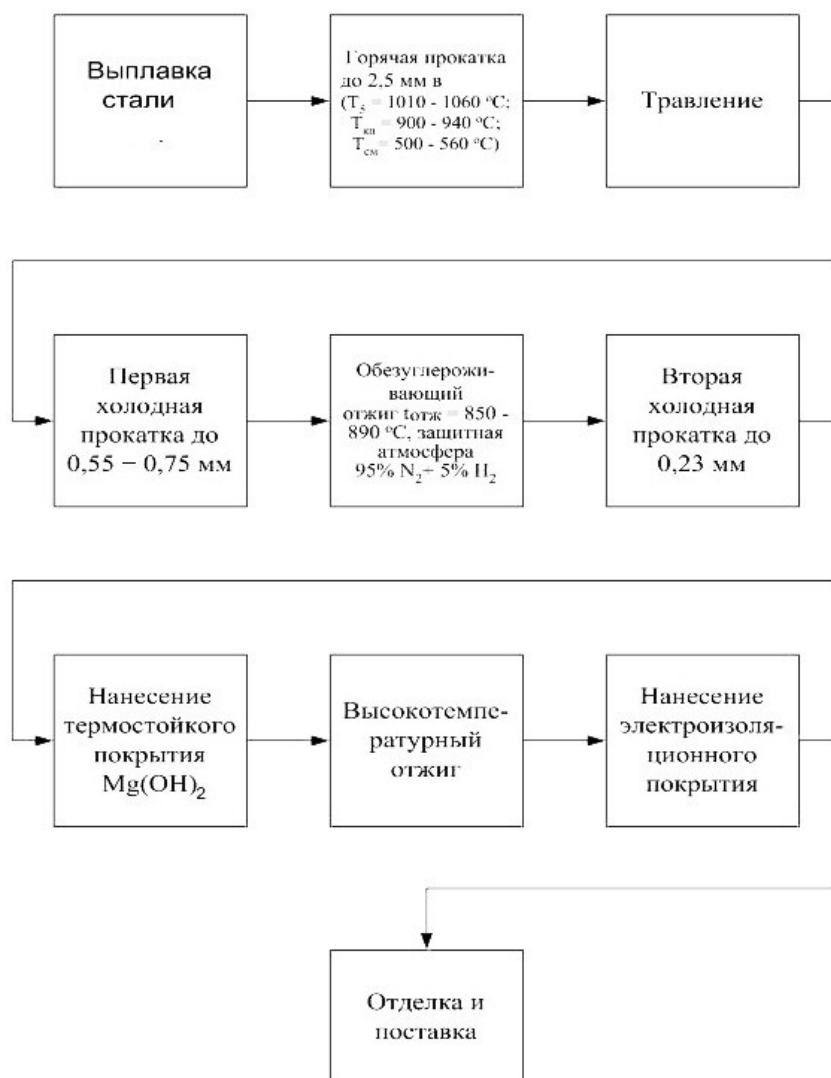
Рисунок 3. Схема производства анизотропной электротехнической стали
