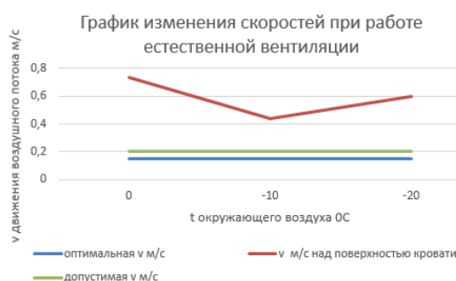
Рисунок 6. График изменения скоростей при работе естественной вентиляции
