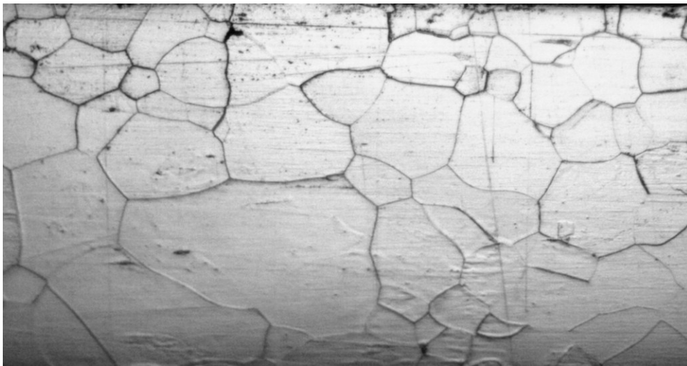
Рисунок 1. Микроструктура изотропной электротехнической стали после термообработки \times 100 травление – 3 % раствором \text{HNO}_3 на спирту
