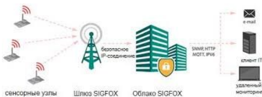
Рисунок 3. Структурная схема сети Sigfox
