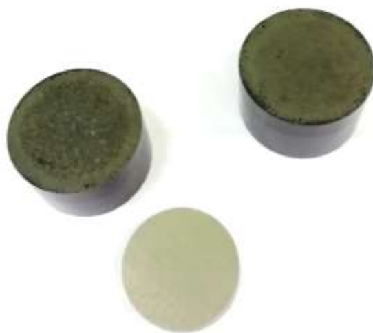
Рисунок 1. Образцы для испытаний: внизу ЭИ961 (13X11H2B2MФ), слева гексагональный VN никелированный, справа графит никелированный
