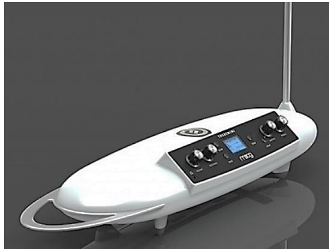
Рисунок 4. Moog Theremini — синтезатор-терменвокс: левая антенна отвечает за громкость, правая — за высоту тона ( https://theremintimes.ru )
