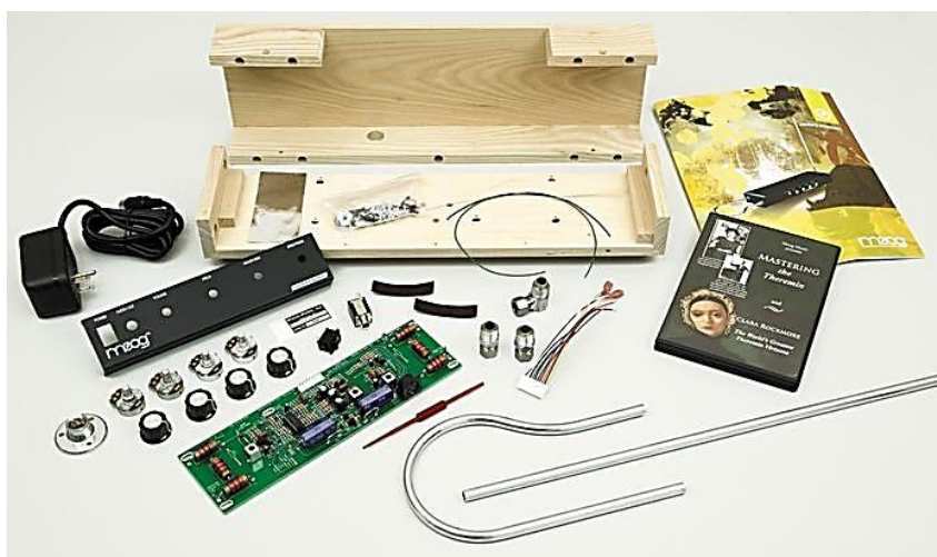
Рисунок 3. Сборочная модель терменвокса Moog Etherwave Kit ( https://theremintimes.ru )
