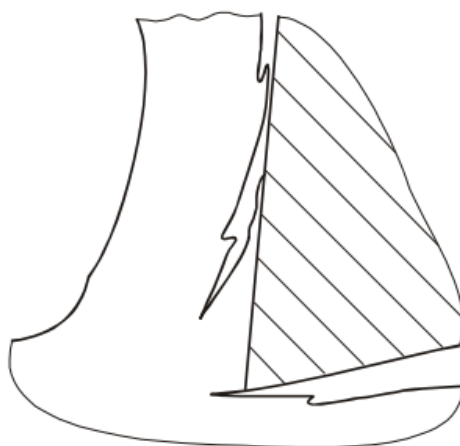
Рисунок 1. схема образования нароста
