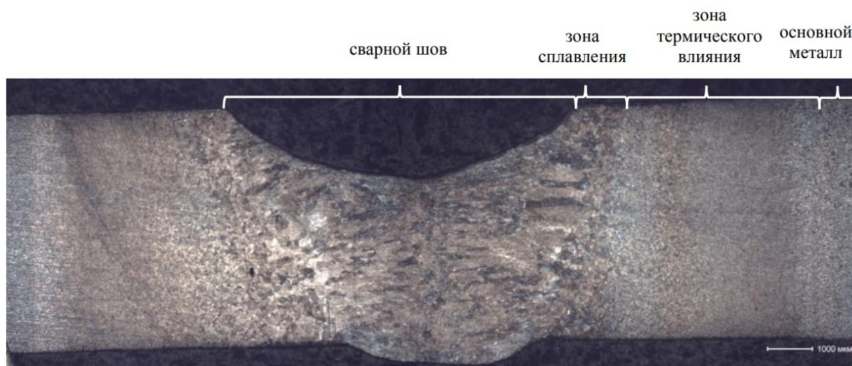
Рисунок 5. Микроструктура сварного соединения «Вилка» – «Труба»
