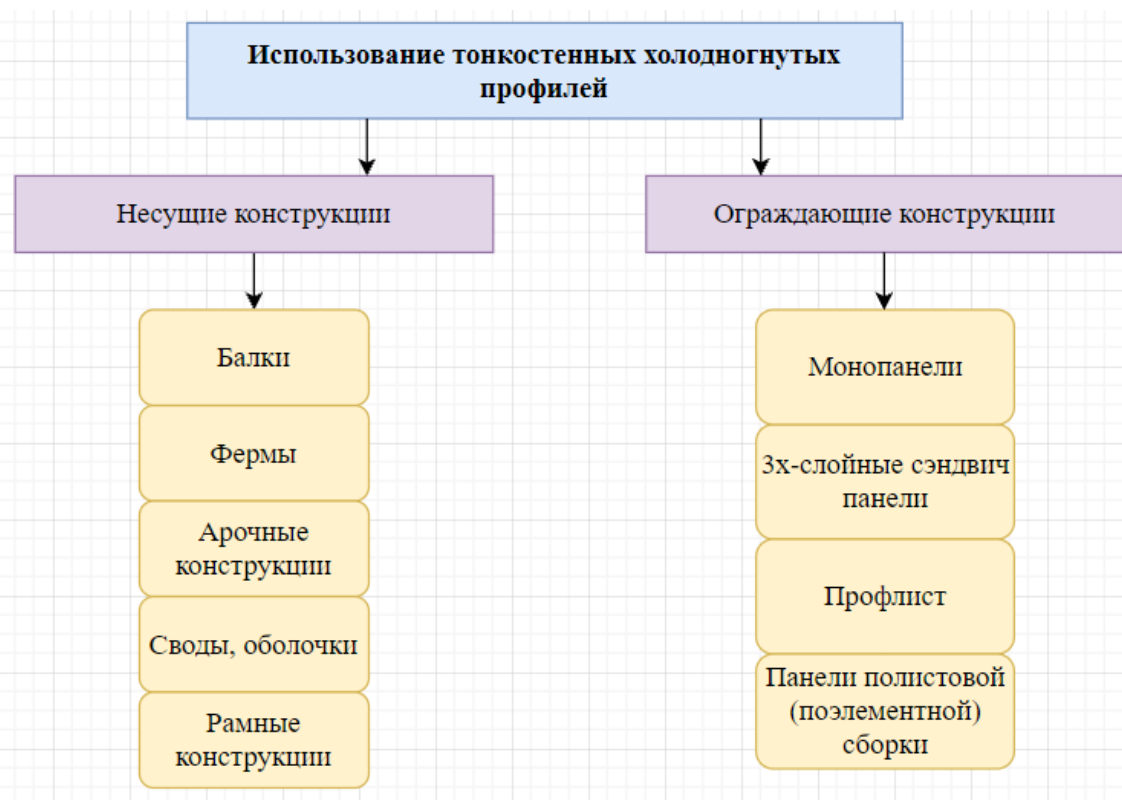
Рисунок 2. Классификация конструкций из тонкостенных холодногнуто́тых профилей
