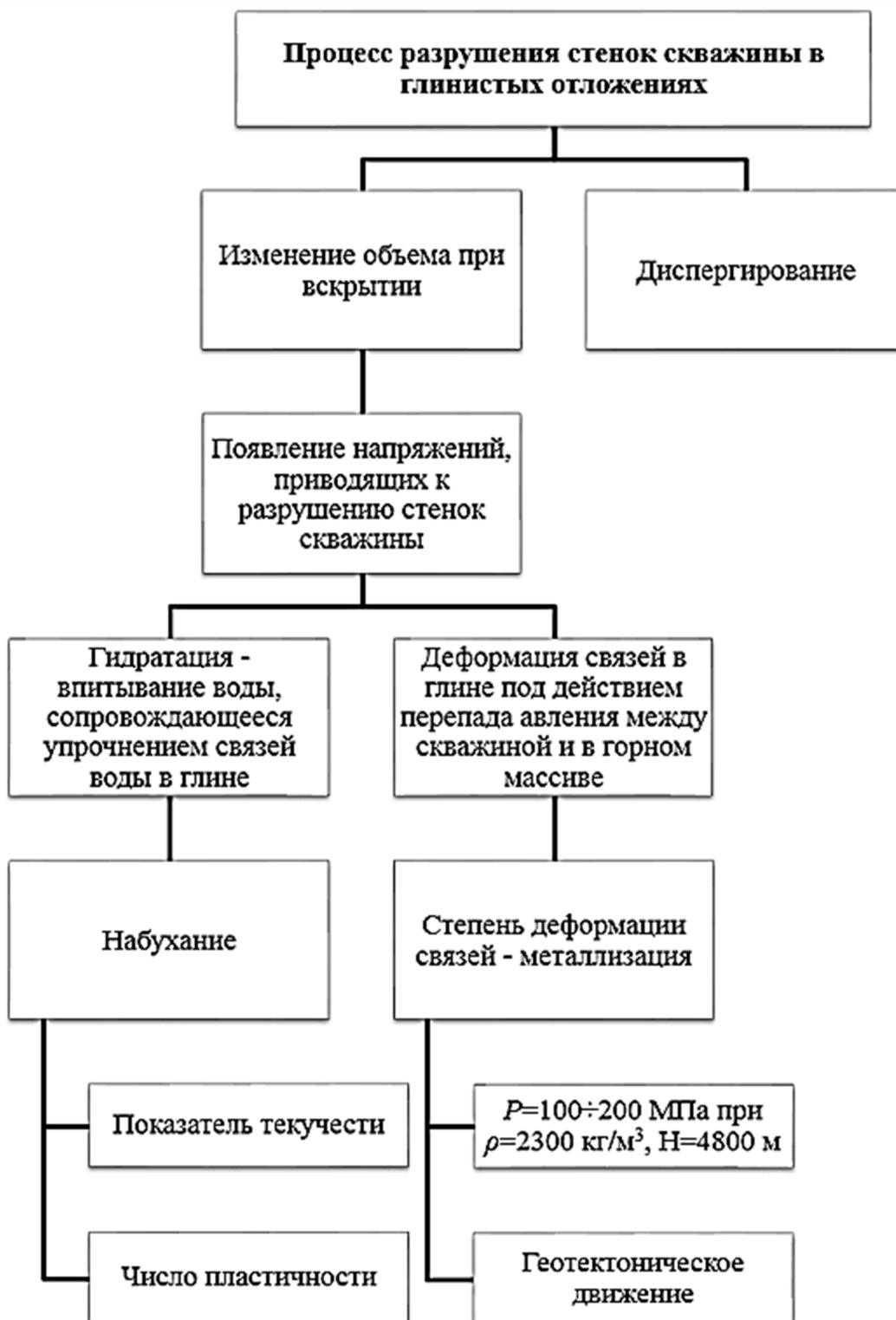
**Рисунок 2.1 – Факторы, определяющие процесс разрушения стенок скважины, сложенных глинистыми отложениями**
