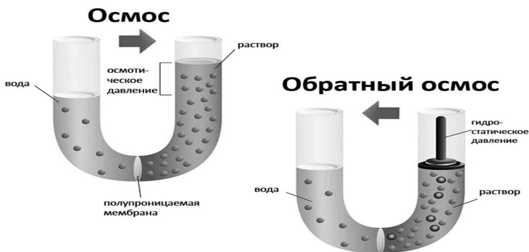
*Рисунок 2. Схема прямого и обратного осмоса*
