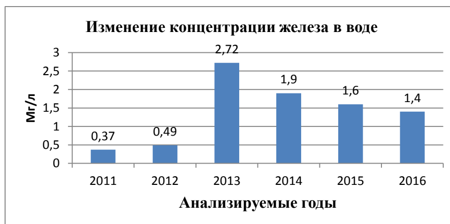
Рисунок 1. Изменение концентрации железа в питьевой воде г. Чита
