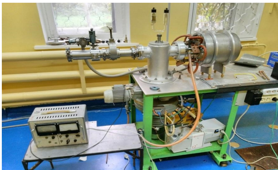
Рисунок 2. Испытательный высоковакуумный стенд для разделения мишенного вещества и целевого радионуклида
