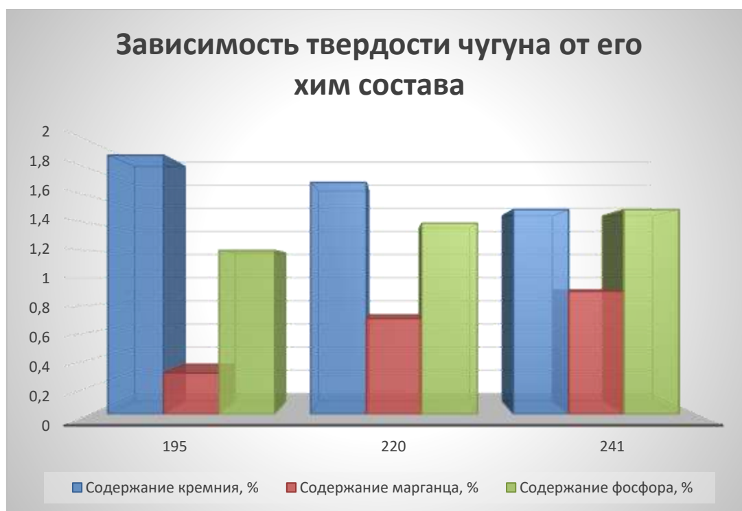
Рисунок 2. Химический состав чугуна при разной величине твердости
