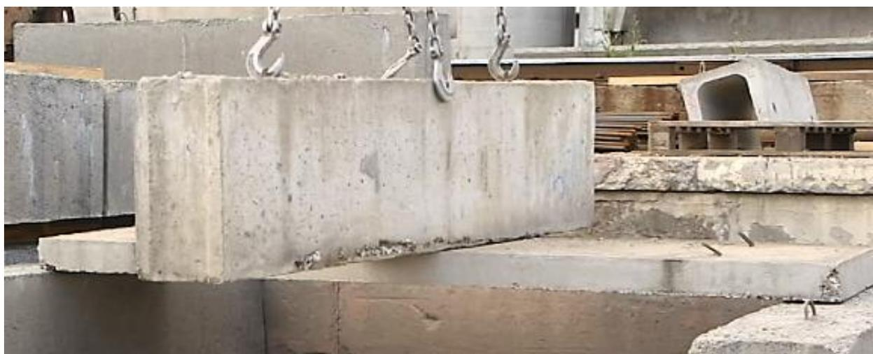
*Рисунок 3. Проверка прочности бетонной плиты*
