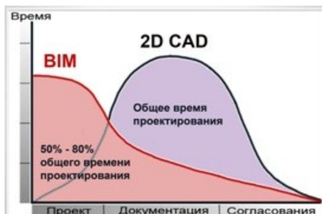
Рисунок 1. Перераспределение времени на проектирование, связанное с внедрением технологии BIM
