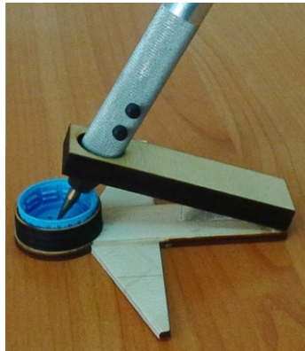
Рисунок 6. Подставка под диагностический электрод
