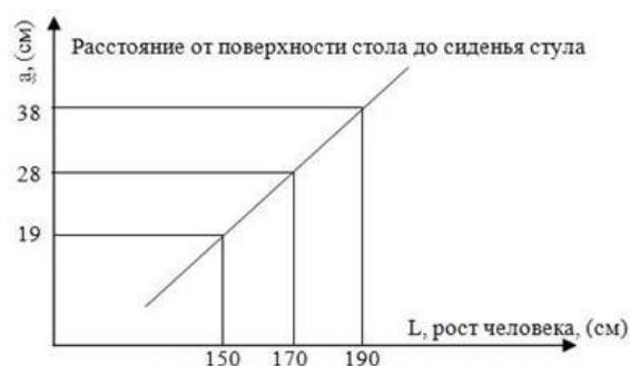
Рисунок 2. Изменение расстояния между поверхностью стола и стулом оператора в зависимости от роста человека
