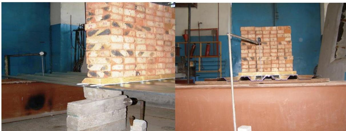
**Рисунок 1. Вид на экспериментальную установку в момент нагружения при определении перемещений при прогибе**
