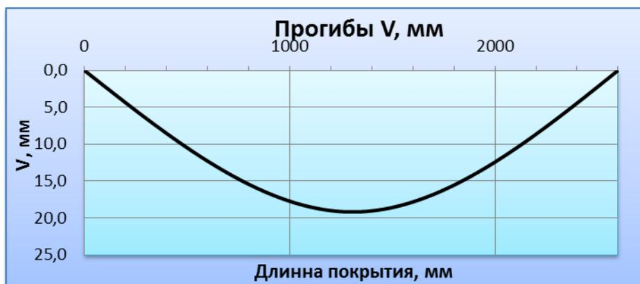
*Рисунок 5. График перемещений при прогибе*
