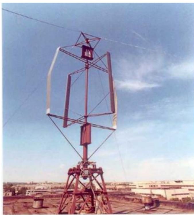
**Рисунок 2. Ветротурбина Бидарье**
