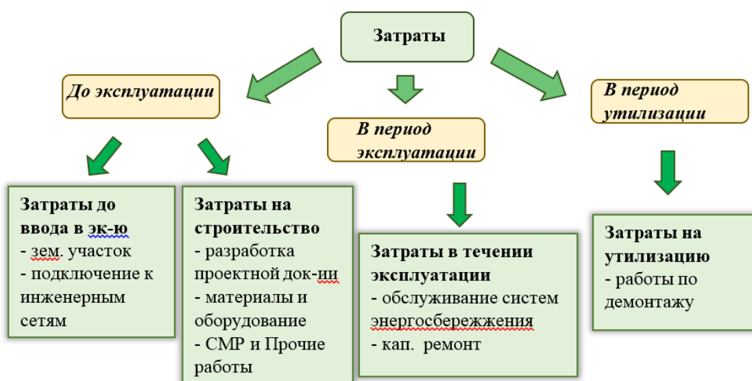
Рисунок 2. Схема распределения затрат в период жизненного цикла
