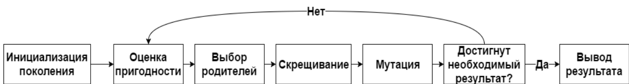
Рисунок 1. Схема работы генетического алгоритма
