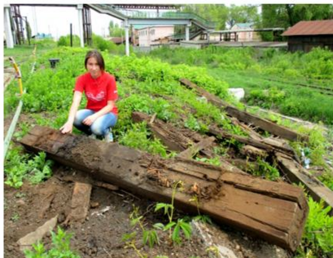
Рисунок 5. Свалка сгнивших деревянных шпал
