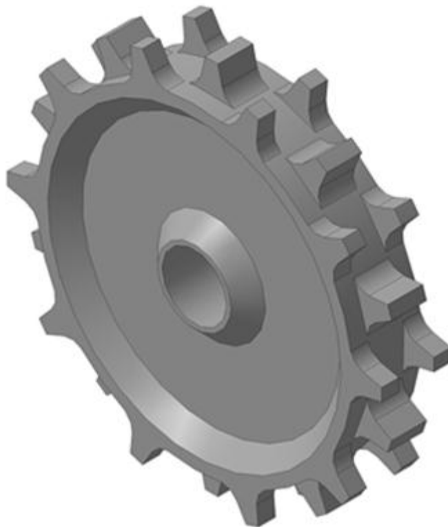
Рисунок 3. Звездочка для предлагаемой цепи по варианту 1
