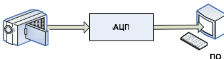
Рисунок 1. Стандартная система машинного зрения
