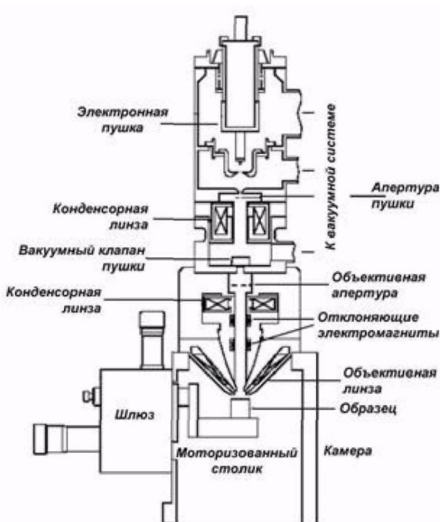
Рисунок 3. Схема устройства современного растрового электронного микроскопа (РЭМ)
