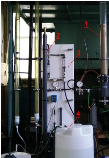
Рисунок 3. Экспериментальная модель реактора. 1 – реактор-осветлитель, 2 – воздухоотделитель, 3 – измерительное оборудование, 4 – бак с чистой промывной воды
