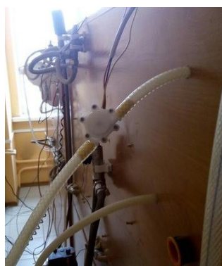
Рисунок 1. Датчик расхода жидкости в лабораторном комплексе
