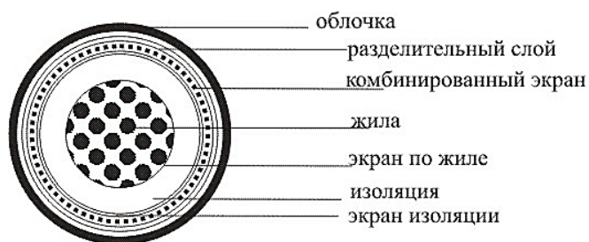
Рисунок 3. Кабель ТУ 16.К71-337–2004 в разрезе
