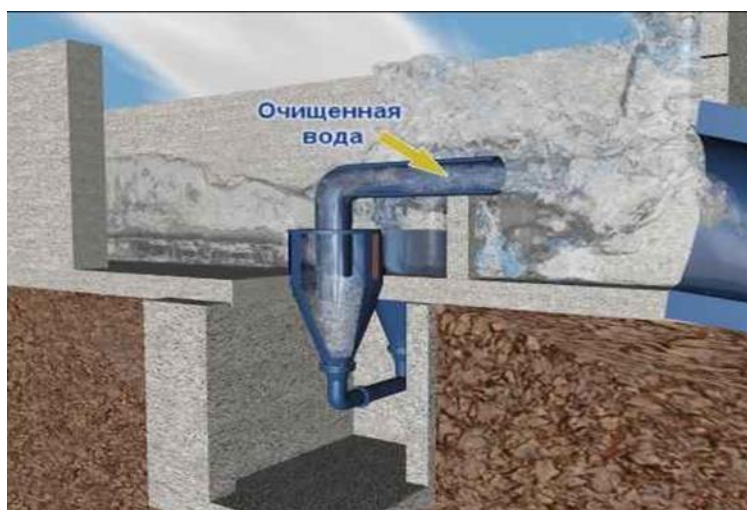
Рисунок 2. Узел водоочистки ГЭС, установленный в головной части водозабора
