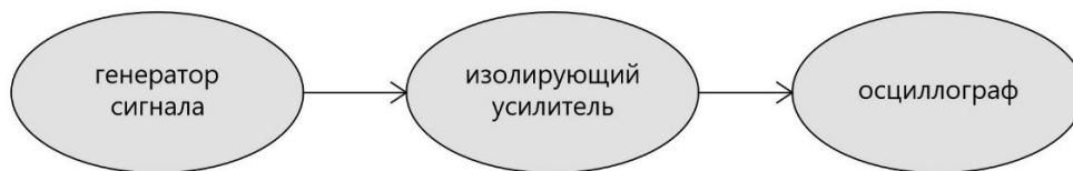
Рисунок 5. Блок-схема измерения ФЧХ и АЧХ ИУ
