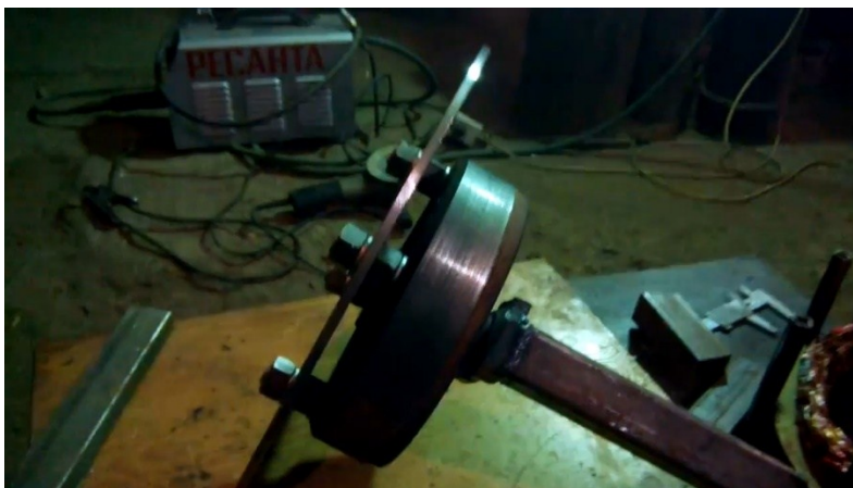
Рисунок 3. Конструкция в статоре и привариваемая к валу
