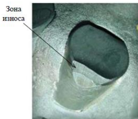
Рисунок 1. - Зона износа фиксированного резца PDC
