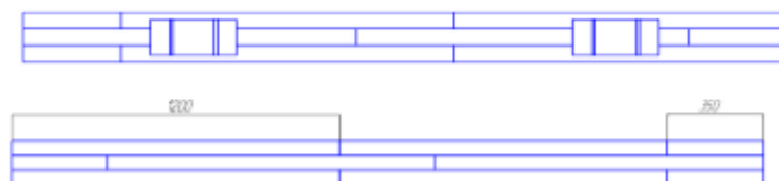
Рисунок 8. 2-ой вариант склеивания деревянных брусков
