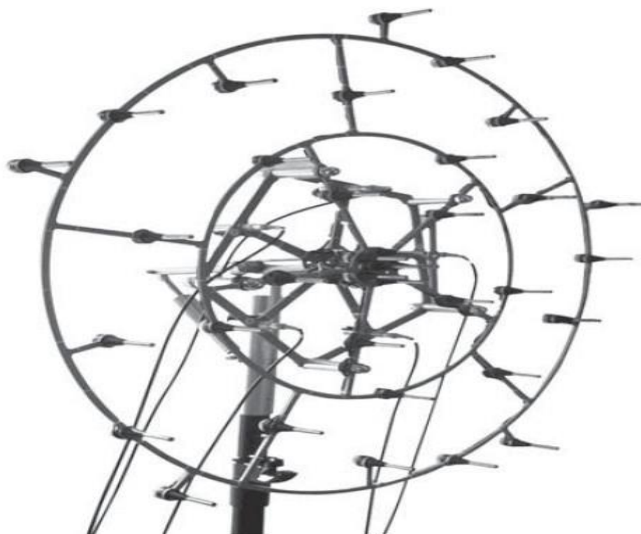
Рисунок 2. Микрофонная решетка BSWA-TECH SPS-980 [2]
