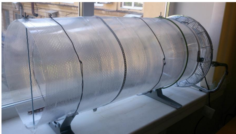
Рисунок 2. Прототип аэродинамической трубы в профиль
