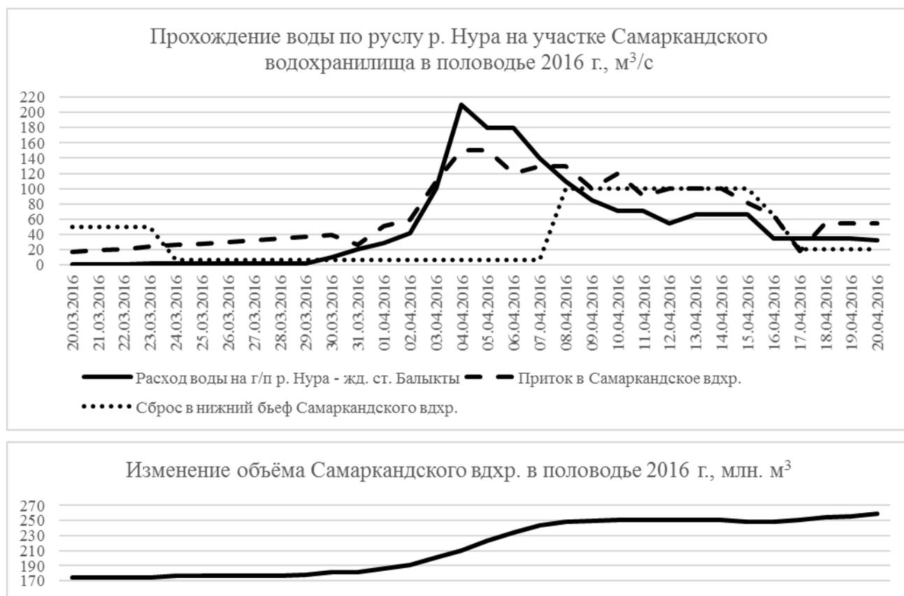
**Рисунок 2. Прохождение воды по руслу р. Нура на участке Самаркандского водохранилища в половодье 2016 г. [2, 3]**
