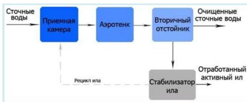
**Рисунок 5. Технологическая схема работы очистной установки «Юнилос»**
