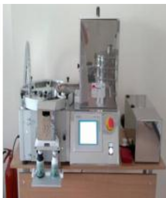
Рисунок 3. Машина для счета и фасовки капсул СРЕ-6
