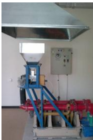
Рисунок 1. Механохимическая установка ЦЭМ 7-80
