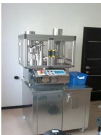
Рисунок 2. Автоматическая машина по наполнению капсул IN-CAP
