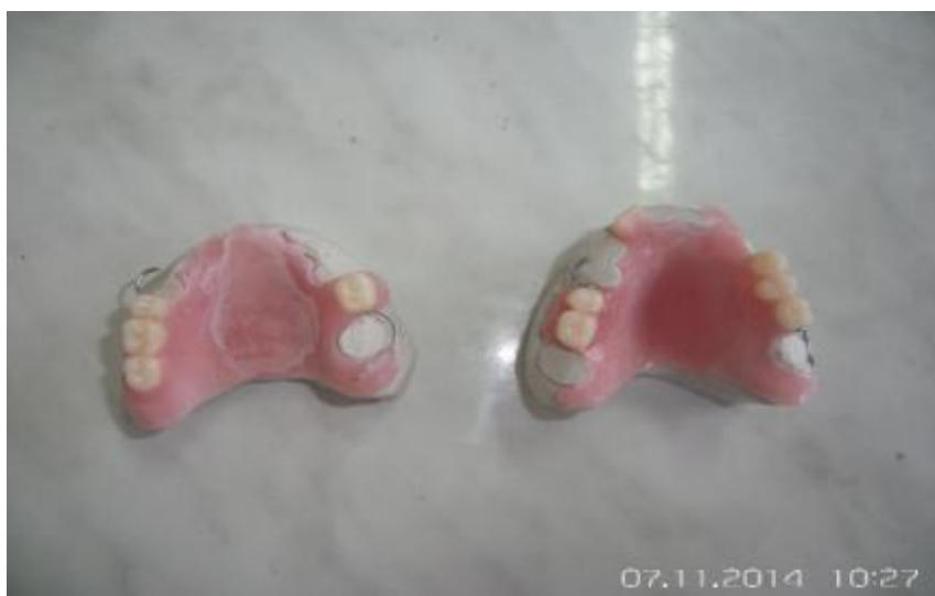
Рисунок 9. Слева образец отполимеризованный на воздухе (образец № 2), справа — в гидрополимеризаторе под давлением (образец № 1) Далее образцы шлифуем и полируем.
