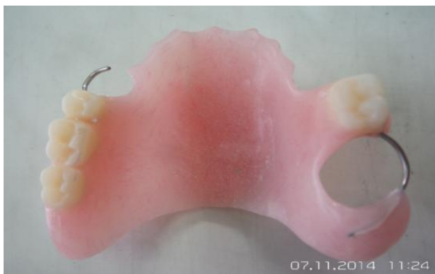
Рисунок 10. На образце № 2 видна пористость пластмассы
