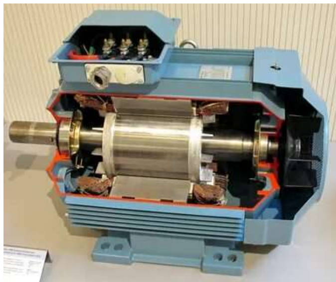
Рисунок 3. Внешне строение двигателя переменного тока и строение в разрезе
