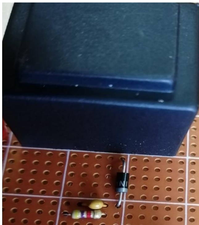
Рисунок 2. «Готовая схема включения выпрямителя»
