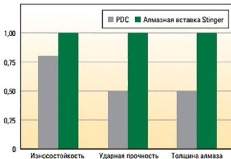
Рисунок 2. Сравнительная характеристика долота PDC и долота со вставками Stinger
