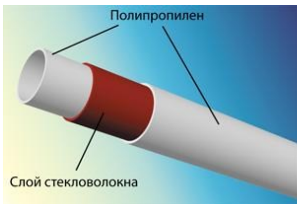
Рисунок 1. 1 - армирование стекловолокном; 2 - армирование перфорированной алюминиевой фольгой
