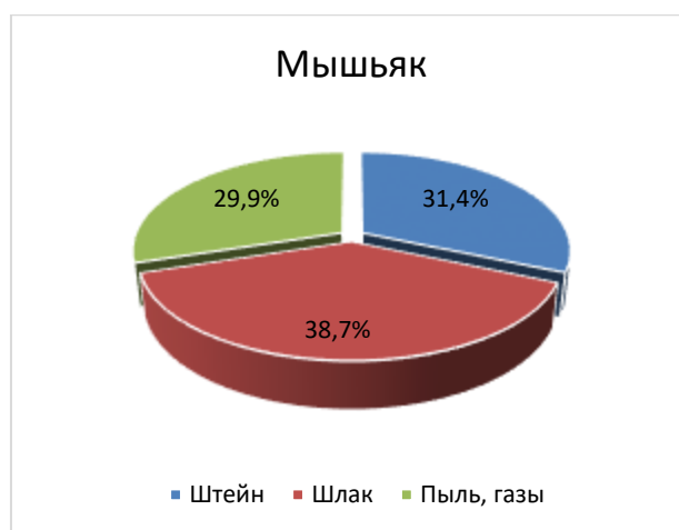
Рисунок 3. Распределение металлов между полученными продуктами электроплавки
