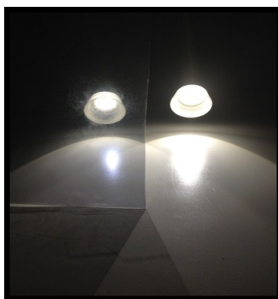
Рисунок 2. Модель фары с использованием поляризационной пленки и без поляризационной пленки
