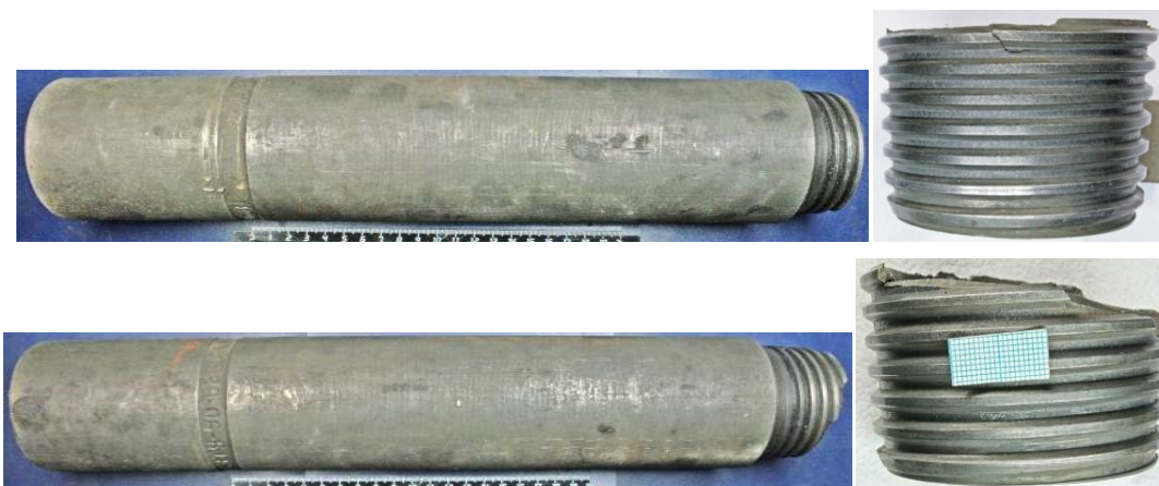
Рисунок 1. Разрушение резьбовых соединений переходников
