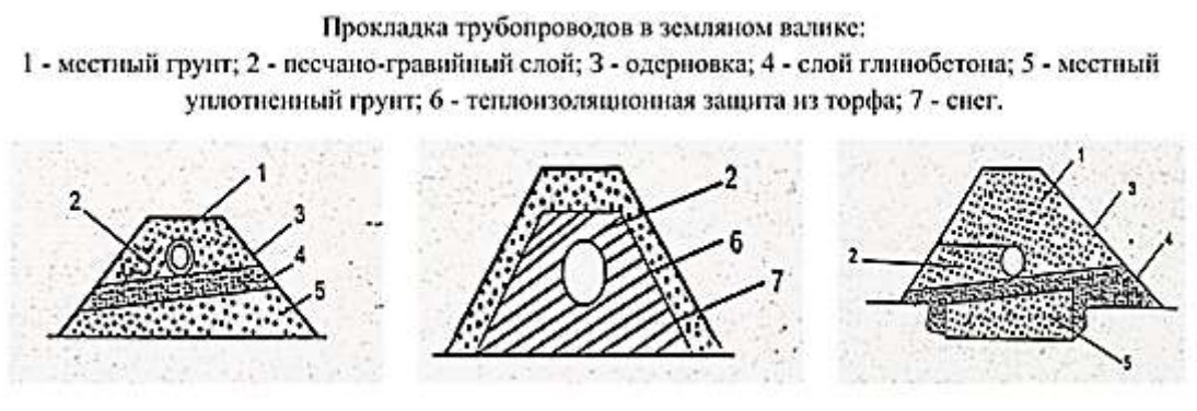
Рисунок 2. Прокладка трубопровода в земляном валике
