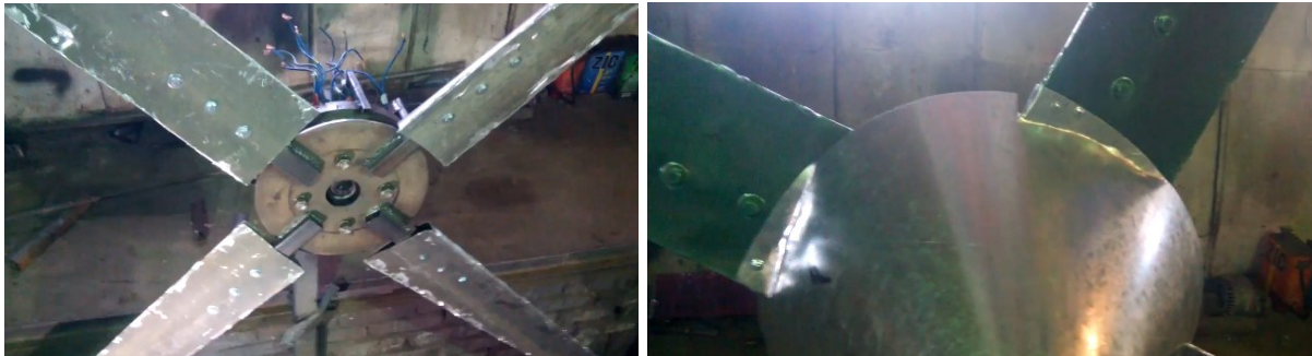
Рисунок 4. Процесс замазывания зазоров эпоксидным клеем
